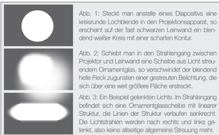
Abb. 1: Steckt man anstelle eines Diapositivs eine kreisrunde Lochblende in den Projektionsapparat, so erscheint auf der fast schwarzen Leinwand ein blendend weißer Kreis mit einer scharfen Kontur.
