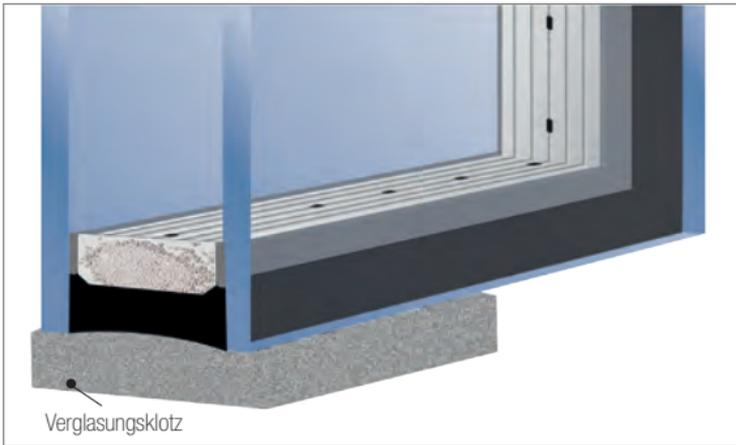
Die Klotzung soll einen freien Glas-Falzraum zur Aufrechterhaltung des Dampfdruckausgleiches (Langzeitkondensation), der Belüftung und ggf. der Entwässerung gewährleisten. Generell sind beim Einbau von Mehrscheiben-Isoliergläsern geeignete Verglasungsklotze bzw. Klotzbrücken zu verwenden. Es müssen alle Scheiben eines Mehrscheiben-Isolierglases nach den anerkannten Regeln der Technik [3] geklotzt werden.
