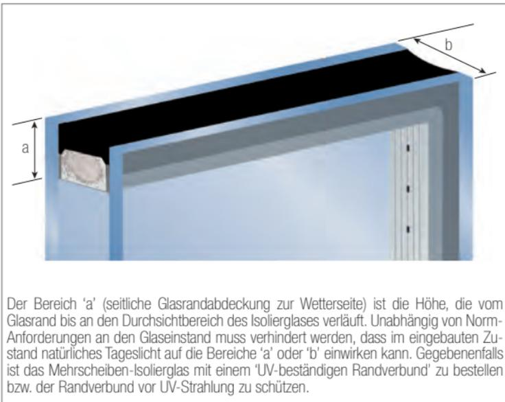
Der Bereich 'a' (seitliche Glasrandabdeckung zur Wetterseite) ist die Höhe, die vom Glasrand bis an den Durchsichtbereich des Isolierglases verläuft. Unabhängig von Norm-Anforderungen an den Glaseinstand muss verhindert werden, dass im eingebauten Zustand natürliches Tageslicht auf die Bereiche 'a' oder 'b' einwirken kann. Gegebenenfalls ist das Mehrscheiben-Isolierglas mit einem 'UV-beständigen Randverbund' zu bestellen bzw. der Randverbund vor UV-Strahlung zu schützen.
