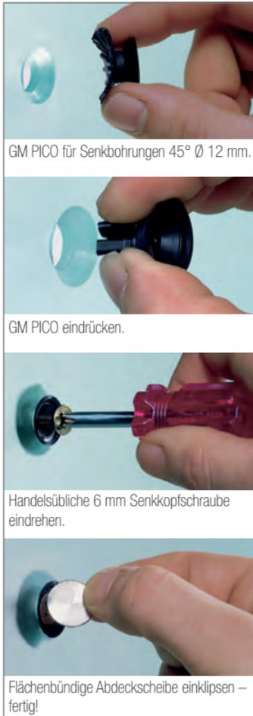
Abb. 8.12: Technischer Aufbau
